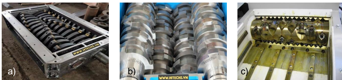
Hình 10: Các loại máy nghiền thường sử dụng: a) Máy nghiền 2 trục; b) Máy nghiền 4 trục; c) Máy nghiền bào thủy lực
