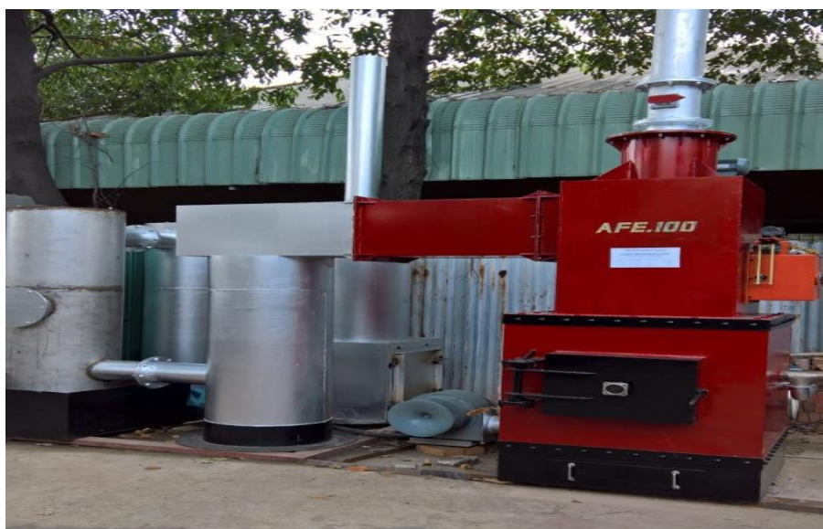
Hình 2. Hình ảnh lò đốt rác hồ quang điện
