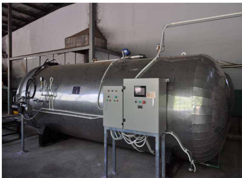
Hình 7. Hệ thống xử lý rác thải y tế bằng phương pháp hấp nhiệt ướt
