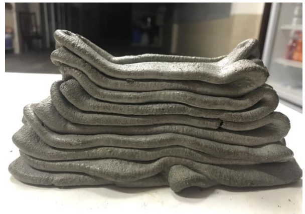
Hình 26. Mẫu bê tông cốt sợi polypropylene ứng dụng trong xây dựng
