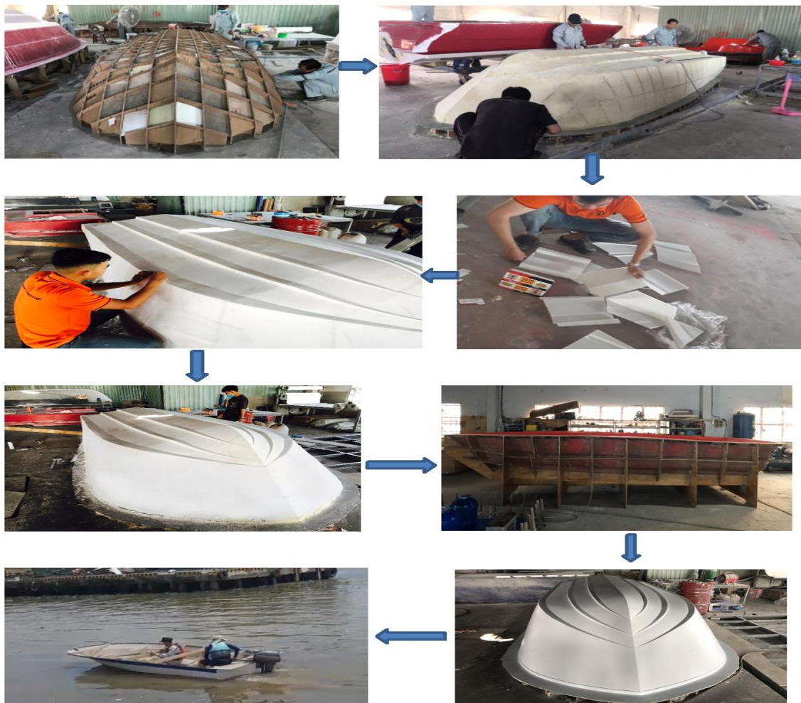
Hình 38. Quy trình chế tạo vỏ tàu theo công nghệ in 3D
