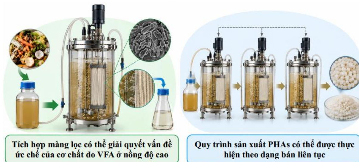
Hình 2.3 Ứng dụng hệ thống phản ứng màng nhúng và vận hành bán liên tục (Nguồn: Tài liệu hội thảo “Xu hướng phát triển và ứng dụng vật liệu phân hủy sinh học.” ngày 23/9/2026)
