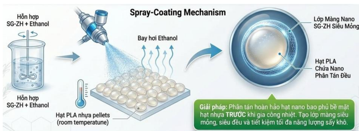
Hình 2.1 Nghiên cứu chế tạo vật liệu nanocomposite phân hủy sinh học polylactide/nanosilica (Nguồn: Tài liệu hội thảo “Xu hướng phát triển và ứng dụng vật liệu phân hủy sinh học.” ngày 23/9/2026)
