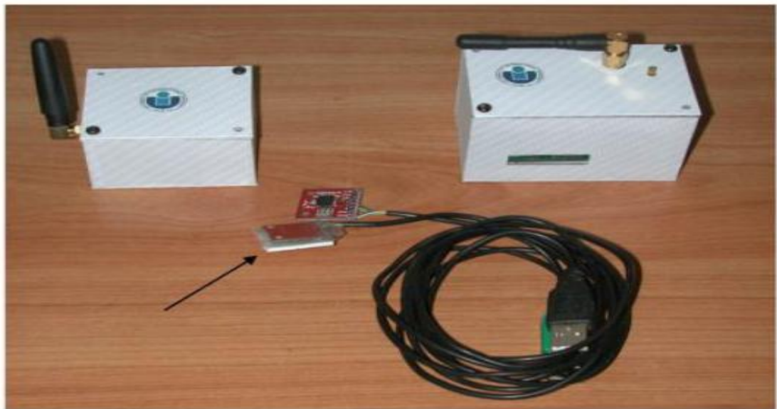
Máy theo dõi nhịp thở từ xa: Hai cảm biến đo gia tốc (mũi tên) được gắn lên ngực và bụng của bệnh nhân. Hình phía sau là 2 giao diện truyền thông do Bộ Môn KTYS thiết kế.
