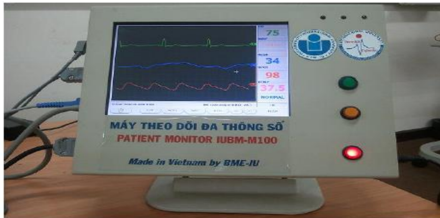
Máy theo dõi đa thông số được đặt tại giường bệnh nhân để liên tục theo dõi các tín hiệu sinh tồn như: nhịp tim HR, chỉ số SPO2, nhịp thở RESP, nhiệt độ TEMP, huyết áp SYST và DIAS. Trên màn hình LCD hiển thị 4 trong 8 kênh ECG I, II, III, aVL, aVR, aVF, SPO2, RESP.
