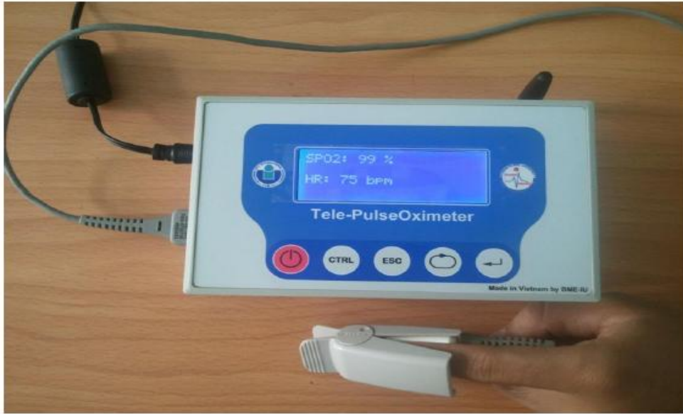
Máy đo SPO2 viễn thông. Các kết quả đo (chỉ số SPO2 và Nhịp tim) được thể hiện lên màn hình, đồng thời gửi về Server qua mạng không dây.
