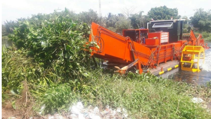
Máy cắt, vớt lục bình trên kênh, rạch, sông, hồ phiên bản B3.0 (2018) do Trung tâm Nghiên cứu và Phát triển Công nghệ - Máy công nghiệp phát triển (Nguồn: Trường đại học Công nghiệp TP.HCM)
