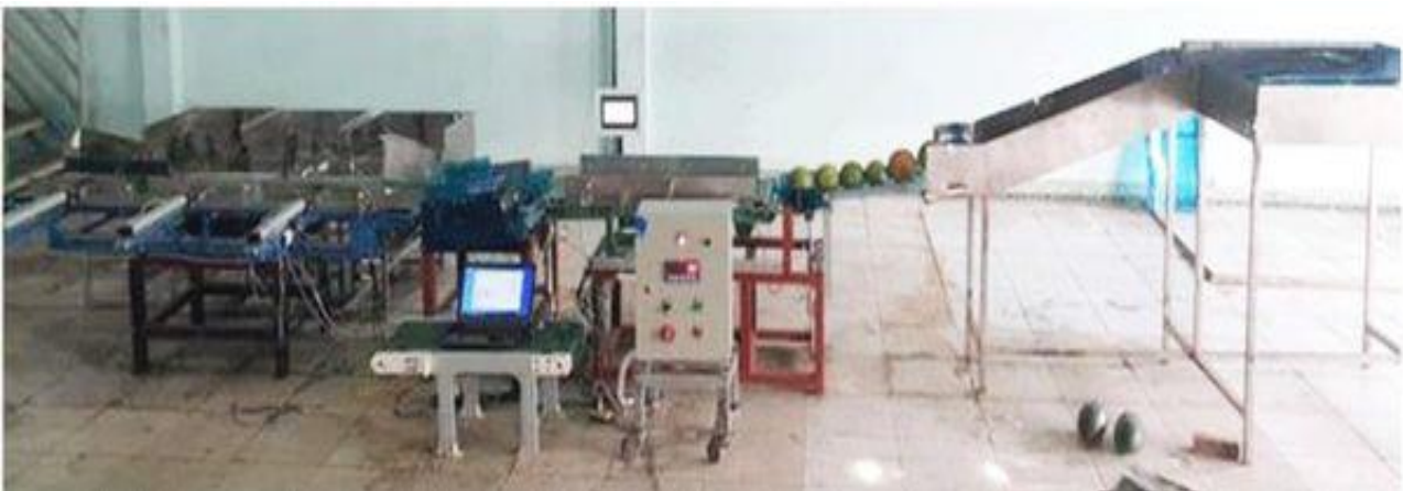
Hình 3. Hệ thống cân và phân loại tự động trái cây. (Nguồn: Báo cáo Kết quả thực hiện nhiệm vụ)
