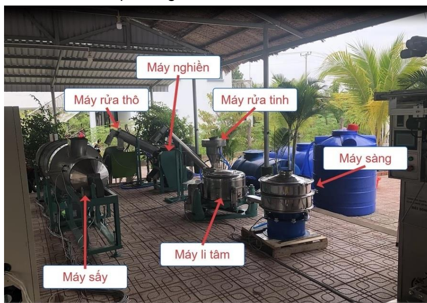
Dây chuyền tinh chế muối được lắp đặt và vận hành thử nghiệm tại HTX Cần Giờ Tương Lai (Nguồn: Sở Khoa học và Công nghệ TP.HCM)
