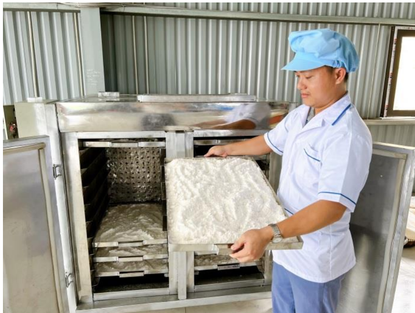
Kết tinh và sấy khô trong quy trình tạo ra sản phẩm muối Nanosalt (Nguồn: Khoa học & Phát triển)
