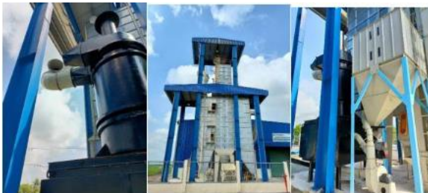
Thiết bị được thử nghiệm trên máy sấy MFD-300-6 của Công ty LAMICO (Nguồn: Kết quả đề tài)
