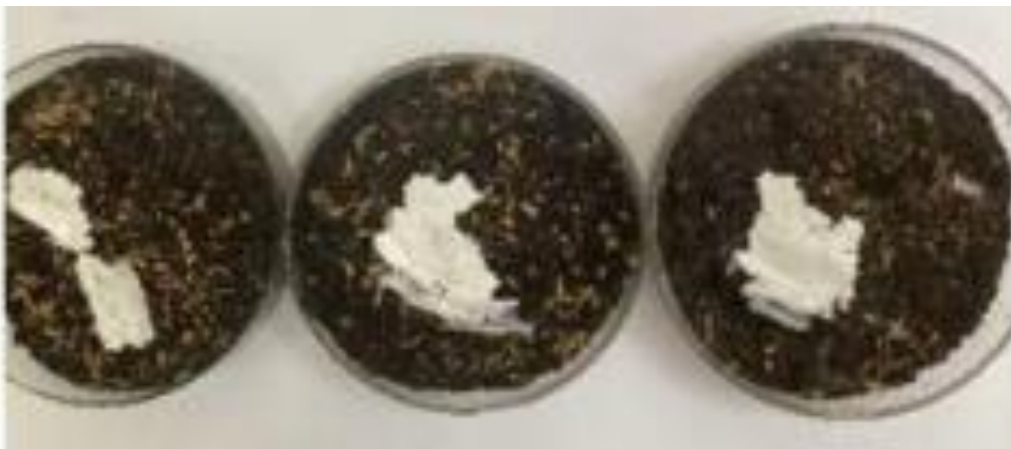
Thử nghiệm khả năng phân hủy của các tấm phim PHB (Nguồn: Kết quả đề tài)
