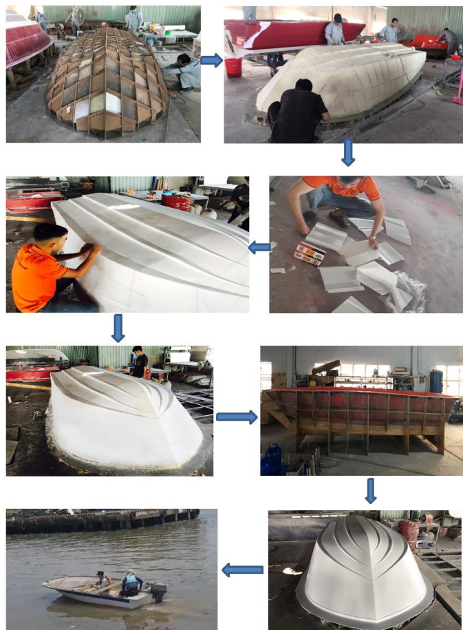
Quy trình chế tạo vỏ tàu cao tốc cỡ nhỏ theo công nghệ in 3D (Nguồn: Kết quả nghiên cứu)
