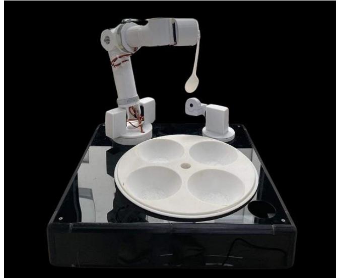
Cánh tay thông minh E-ARM hỗ trợ người gắp khó khăn trong ăn uống (Nguồn: khoa hoc phat trien.vn)
