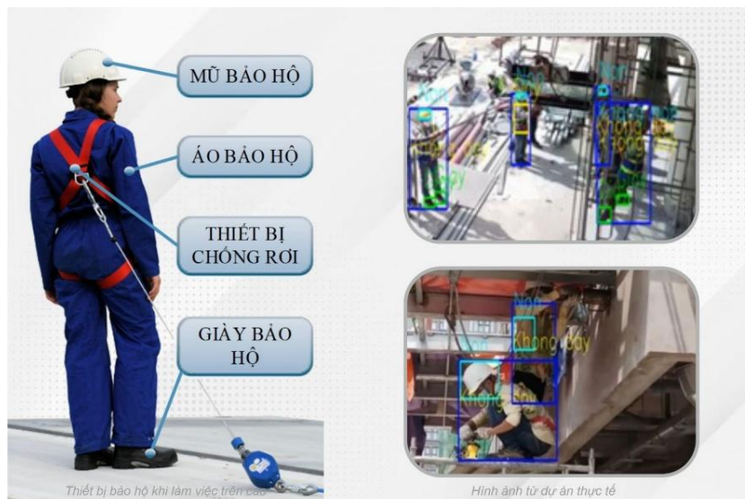
Ứng dụng thuật toán YOLOv8 trên camera để nhận diện thiết bị bảo hộ cá nhân (Nguồn: Kết quả nghiên cứu)
