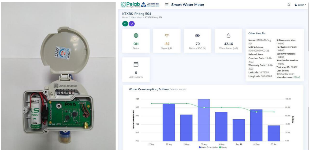
Đồng hồ cơ Itron được gắn cụm đo đếm dữ liệu và thu - phát sóng LoRa, và giao diện giám sát lượng nước tiêu thụ (Nguồn: Kết quả nghiên cứu)
