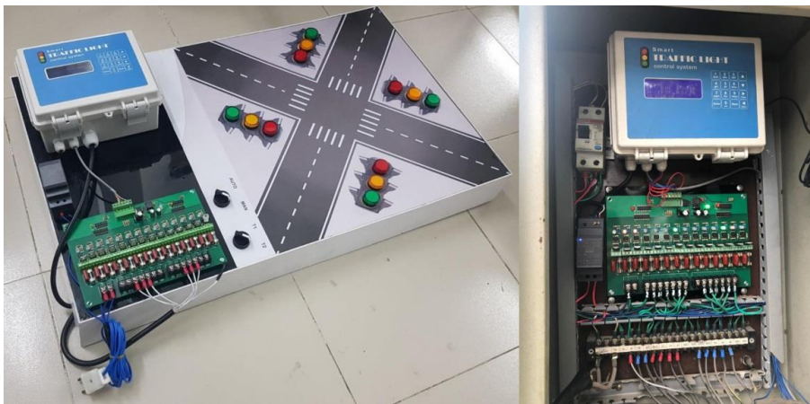
Mô hình và thực tế lắp đặt PLC-IoT Datalogger vào tủ trụ giao thông (Nguồn: Kết quả nghiên cứu)
