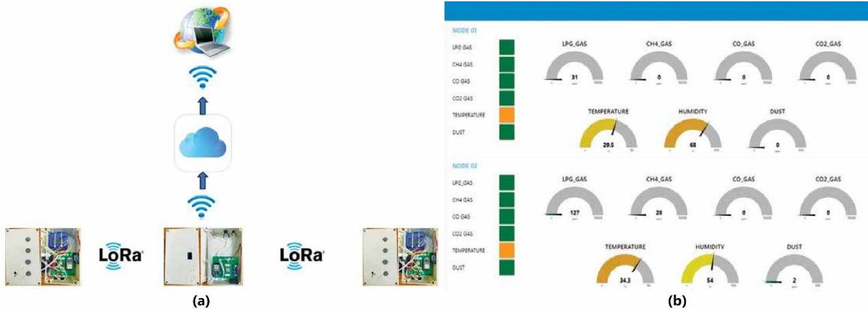
Mô hình (a) và giao diện cảnh báo (b) của hệ thống giám sát an toàn hầm lò sử dụng công nghệ IoT (Nguồn: Kết quả nghiên cứu)
