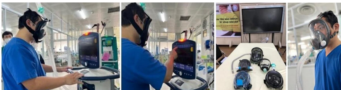
Mặt nạ với hệ thống làm mát khép kín cho nhân viên y tế (Nguồn: Kết quả nghiên cứu)
