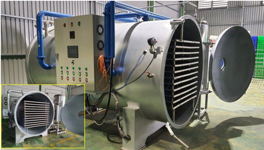
Máy sấy chân không thanh long, năng suất 500kg/mẻ (HCMUT, Trần Anh Sơn, 2022) (Nguồn: Sở Khoa học và Công nghệ TP.HCM)
